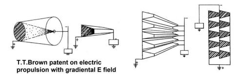
Здесь два электрода разной площади взаимодействуют через трапецевидный диэлектрик. Данный вариант создания градиента электрического поля не единственный, есть и другие методы. Например, градиент электрического поля между двумя одинаковыми плоскими электродами можно создать за счет плавного изменения свойств диэлектрика по его толщие. Браун также указал на этот способ в своем патенте.
