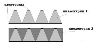
Другое интересное дополнение к этой теме, по данным моих экспериментов, состоит в использовании упругих материалов для трапецевидных диэлектриков, а также при перезарядке электродов в импульсном режиме питания. Импульсы должны быть переменной полярности. Каждый импульс создает кинетический момент. Частотой импульсов можно регулировать тягу.
