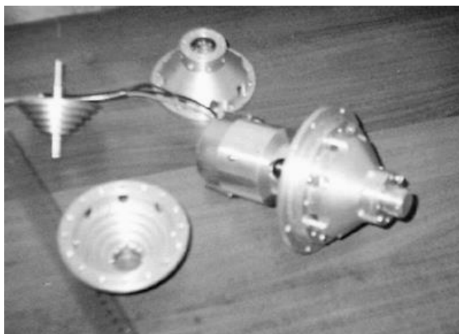
Рис. 24. Фото деталей экспериментального вихревого движителя, 2002 год.
