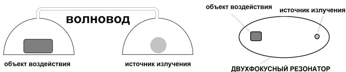
Рис. 132. Резонатор продольных волн с двумя фокусами.
