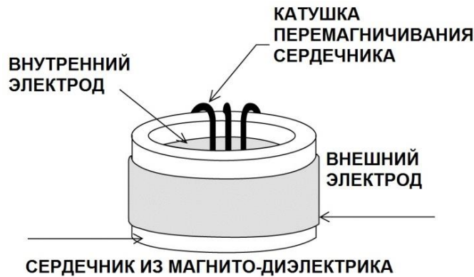
Рис. 71. Схема двигателя Иванова.
