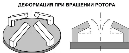
Рис. 125. Двигатель с упругими элементами, в состоянии вращения.
