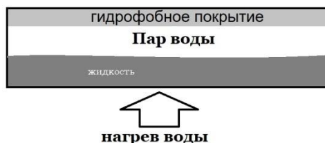
Рис.97. Движитель в замкнутом корпусе с парами воды и гидрофобным покрытием
