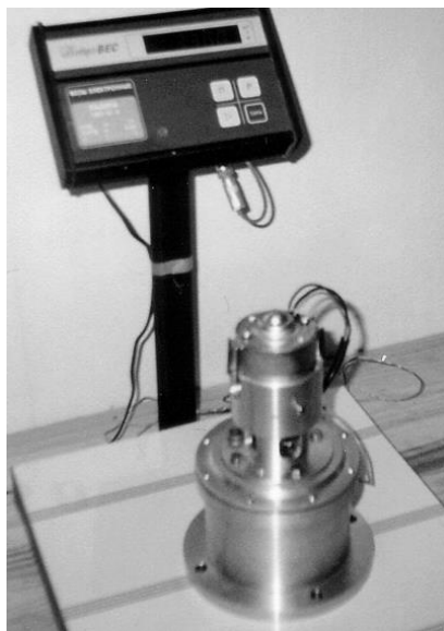
Рис. 25. Фото из архива ООО «АНТФ», 2002 год, вихревой движитель на весах.
