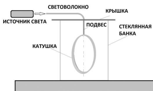
Рис. 140. Эксперимент Золотарева с катушкой из световода.
