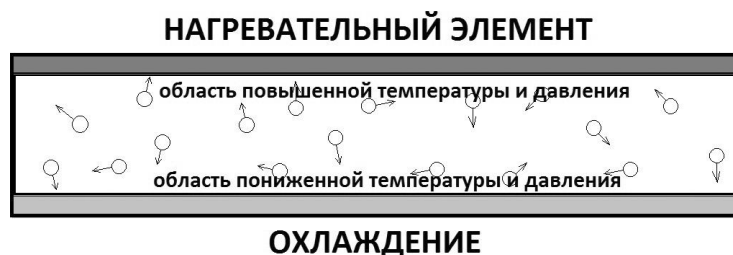
Рис. 109. Схема двигателя, использующего градиент температуры внутренней среды.
