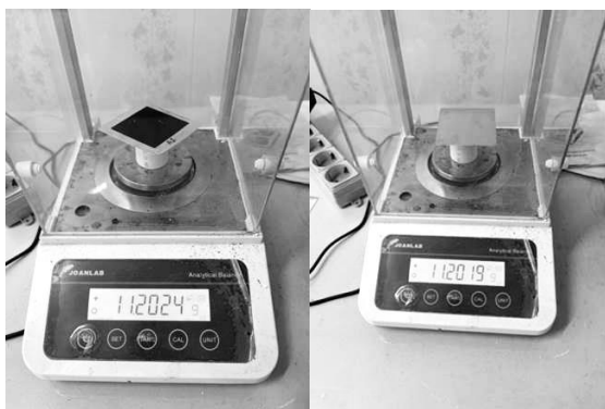
Рис. 101. Взвешивание пластины с односторонним нанорельефом
