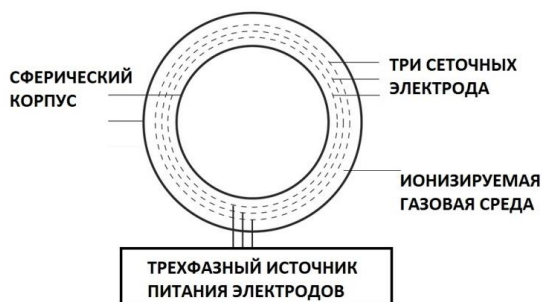
Рис. 161. Схема расположения трех сеточных электродов в пространстве между внешним и внутренним корпусом сферической формы.
