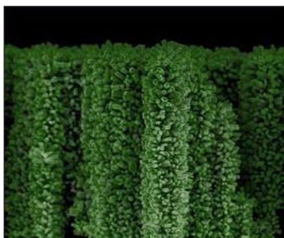
Результаты моих первых экспериментов по данной теме убедительно показали снижение затрат электроэнергии в несколько раз по сравнению с обычными плоскими электродами. Надо отметить, что качество воды не имеет большого значения, то есть, здесь дистиллят и высоковольтные схемы управления электролизом не требуется.
