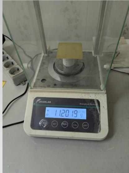
Суть теста в том, что плата с наноматериалом взвешивается на точных весах. Вес пластины в положении «нанопокрытие вверх» и «нанопокрытие вниз» должен отличаться, если есть эффект взаимодействия с молекулами воздуха.
