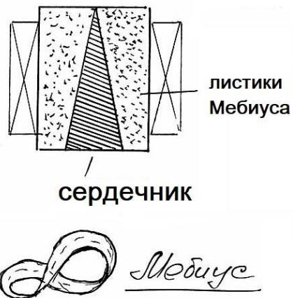
Внутри соленоида, создающего магнитное поле возбуждения, находятся тысячи мелких элементов, изготовленных вручную. Каждый элемент представляет собой листик Мебиуса из металлической плоской ленты. Для электрической изоляции друг от друга, все элементы покрашены лаком. Импульсы возбуждения в соленоиде короткие, около 10 в минус 9 секунды, но мощные.
