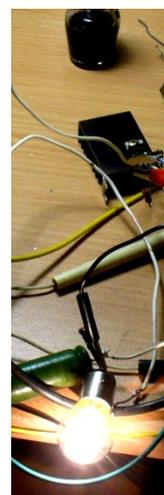
На Фото 12 показан ток потребления этого же трансформатора, но уже под нагрузкой. Я уже говорил, что нагрузкой трансформатора является лампа накаливания. Мной было измерено в это время напряжение на лампе и ток. Они составили 4,8В и 0,9А соответственно, а потребляемая лампой мощность составляет 4,32 Вт.
