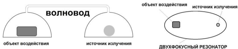
Рис. 122. Резонатор продольных волн с двумя фокусами.
