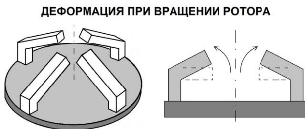
Рис. 116. Движитель с упругими элементами, в состоянии вращения.
