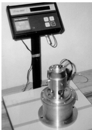
Рис. 24. Фото из архива ООО «АНТФ», 2002 год, вихревой движитель на весах.
