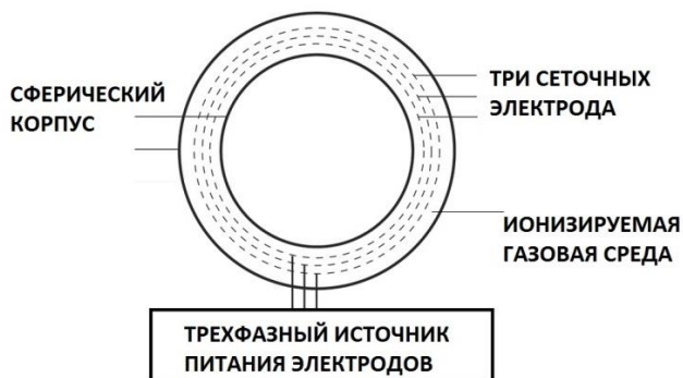
Рис. 149. Схема расположения трех сеточных электродов в пространстве между внешним и внутренним корпусом сферической формы.
