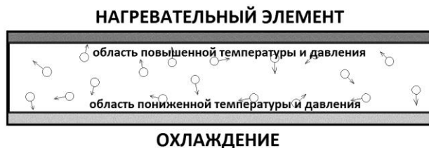
Рис. 100. Схема двигателя, использующего градиент температуры внутренней среды.
