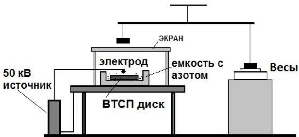
Рис.99. Схема эксперимента по влиянию электрического разряда на фазовое состояние охлажденного ВТСП материала.
