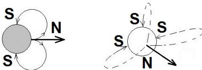
Рис. 51. Предположения о структуре многополюсных магнитов.
