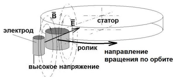
Рис. 60. Схема скрещенных электрических и магнитных полей.
