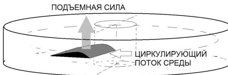
Рис. 7. Крыло в замкнутом потоке среды.
