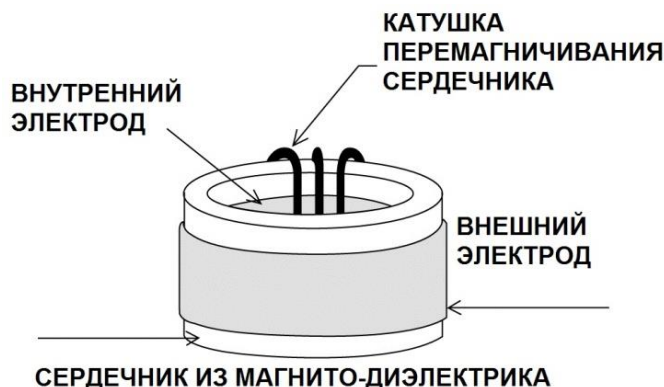
Рис. 67. Схема двигателя Иванова.
