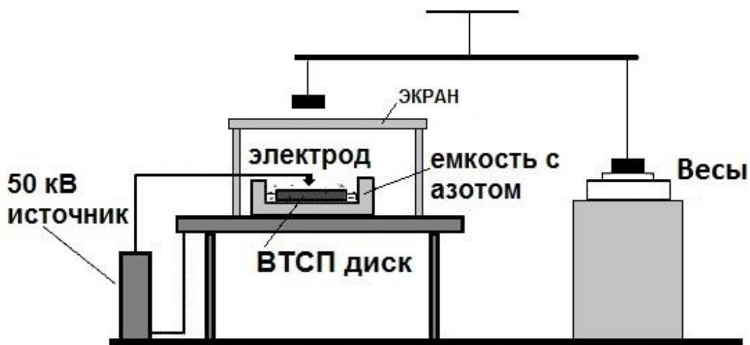
Рис.106. Схема эксперимента Фролова по влиянию электрического разряда на фазовое состояние охлажденного ВТСП материала.
