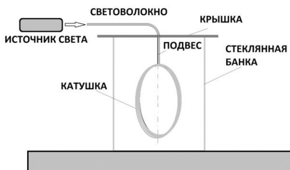
Рис. 130. Эксперимент Золотарева с катушкой из световода.
