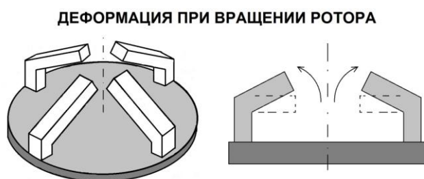
Рис. 116. Двигатель с упругими элементами, в состоянии вращения.
