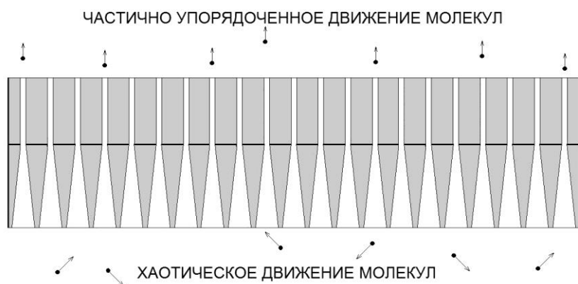
Рис. 87. Создание упорядоченного потока частиц газовой среды.
